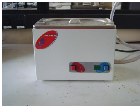
Figura 30: Ultrassom utilizado na preparação das nanofibras para o UV-vis.
