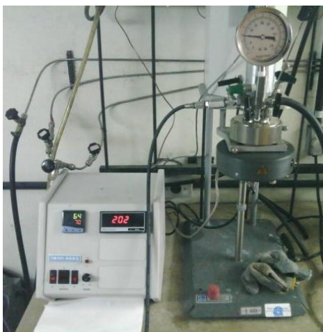
Figura 25: Reator PARR utilizado nas polimerizações.
