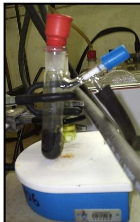
Figura 4.5. Nanolâminas de grafite sendo tratadas com MAO.
