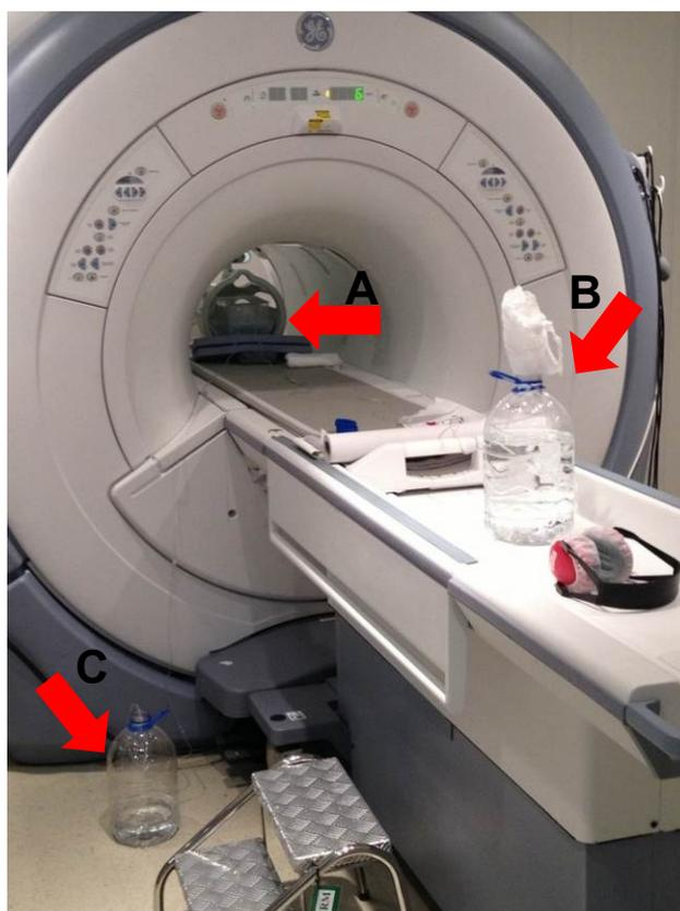
Nota: As setas na figura indicam, respectivamente, A: dispositivo de teste no interior da bobina de crânio e do equipamento de RM; B: recipiente 1 com o líquido que circulou através da mangueira; C: recipiente 2 para receber o líquido após circular através da mangueira.
