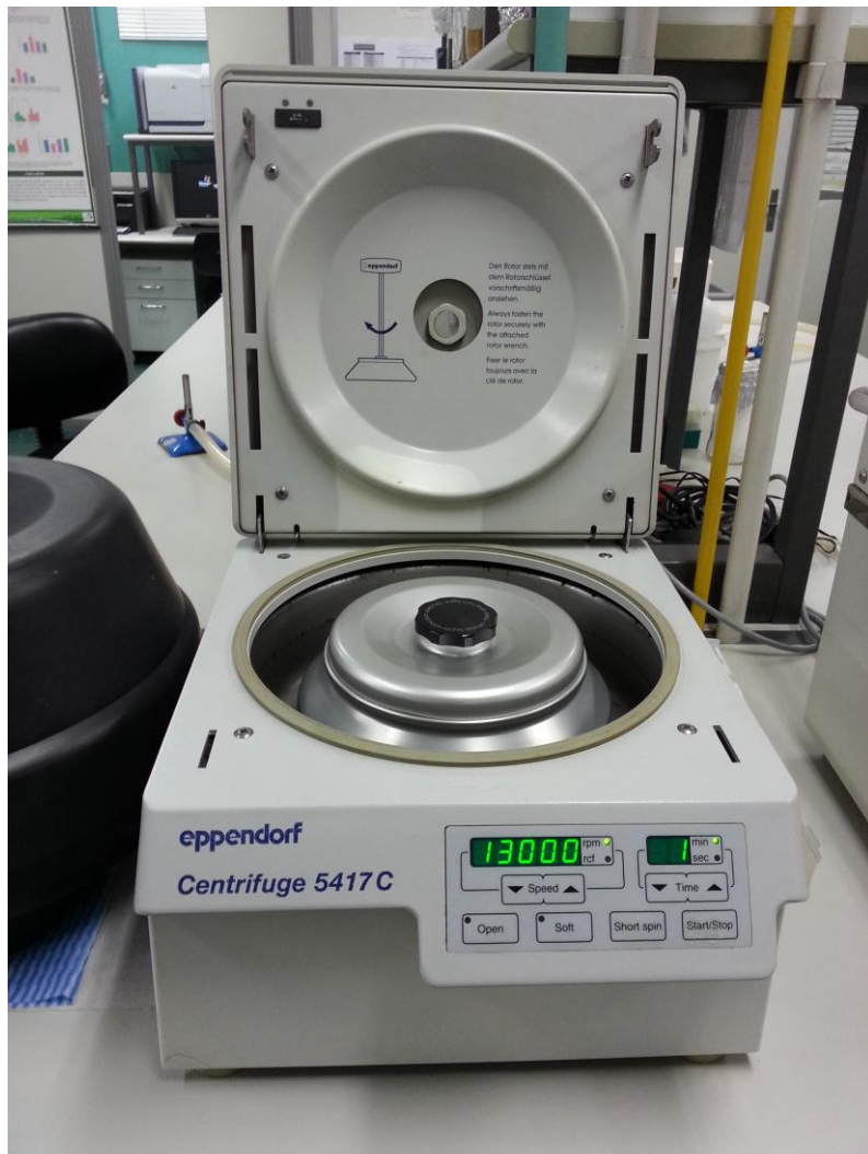
Figura 40 – Microcentrífuga utilizada para isolamento e purificação do mRNA
