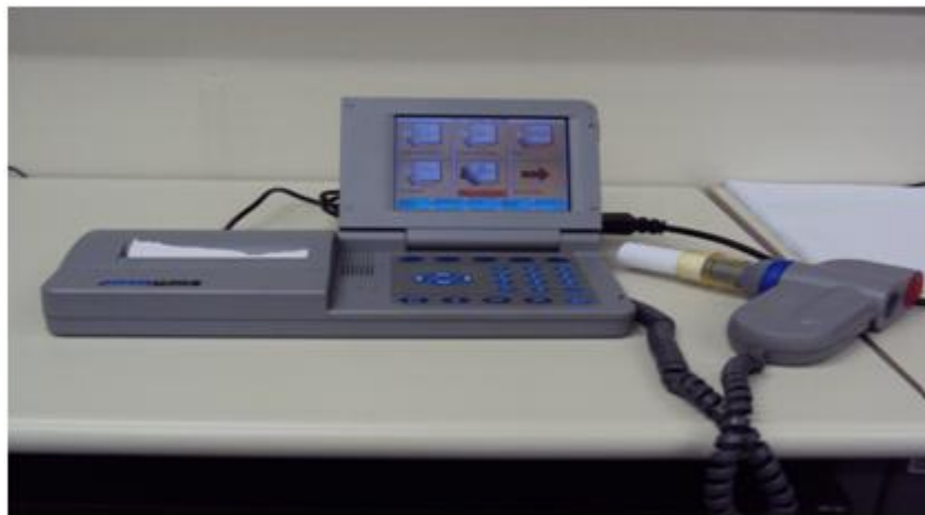
Figura 2- Imagem do equipamento “Super Espiro”. À esquerda podemos notar a impressora dos exames, tela inicial onde visualizamos o exame e à direita o transdutor do Rint + bocal descartável.
