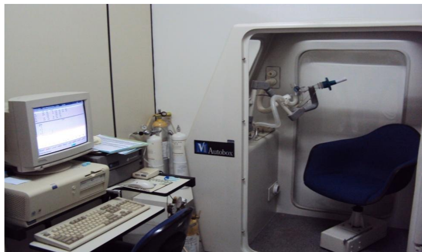
Figura 5- À esquerda observamos o computador e os gases medicinais especiais. À direita cabine de fibra de vidro hermética com o pletismógrafo.
