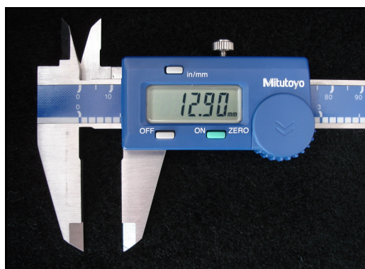
FIGURA 26: Paquímetro Eletrônico Digital Mitutoyo®, utilizado na obtenção das medidas lineares da mandíbula e dos biomodelos. FONTE: Dados da pesquisa, Pós-Graduação em CTBMF, FO/PUCRS, 2006.
