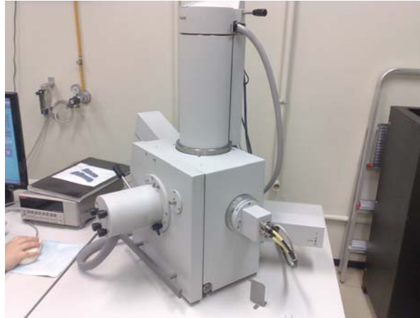
Figura 3. Aparelho de microscopia eletrônica de varredura (MEV) e espectroscopia por dispersão de energia (EDS)
