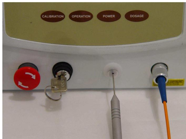
Figura 8 – Chave Liga/Desliga; Botão de Emergência; Calibrador da
