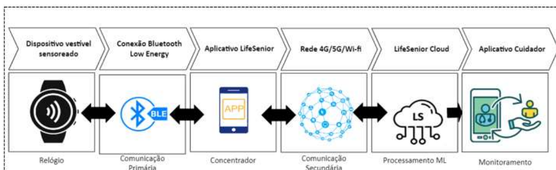
Figura 2. Versão comercial do sistema de monitoramento de saúde LifeSenior (Fonte: [7]).
