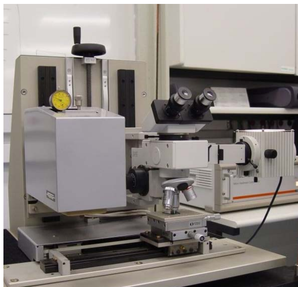
Figura 4. Equipamento de Medida de Dureza Fischerscope HV 100 em funcionamento no GEPSI – Tecnopuc.
