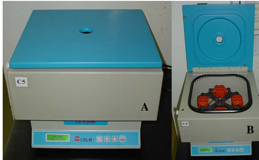
Fig. 05: A e B minicentrífuga utilizada para centrifugação sanguínea. Fonte: Programa de Pós-Graduação em CTBMF da FO/PUCRS, Porto Alegre, 2003.
